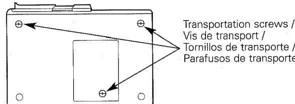
Transportation screws / Vis de transport / Tornillos de transporte / Parafusos de transporte
