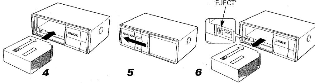
**1.** Asegúrese de que el cartucho de discos esté debidamente orientado hacia arriba, con el logotipo "disc" hacia arriba. Extraiga la bandeja por medio del saliente.
